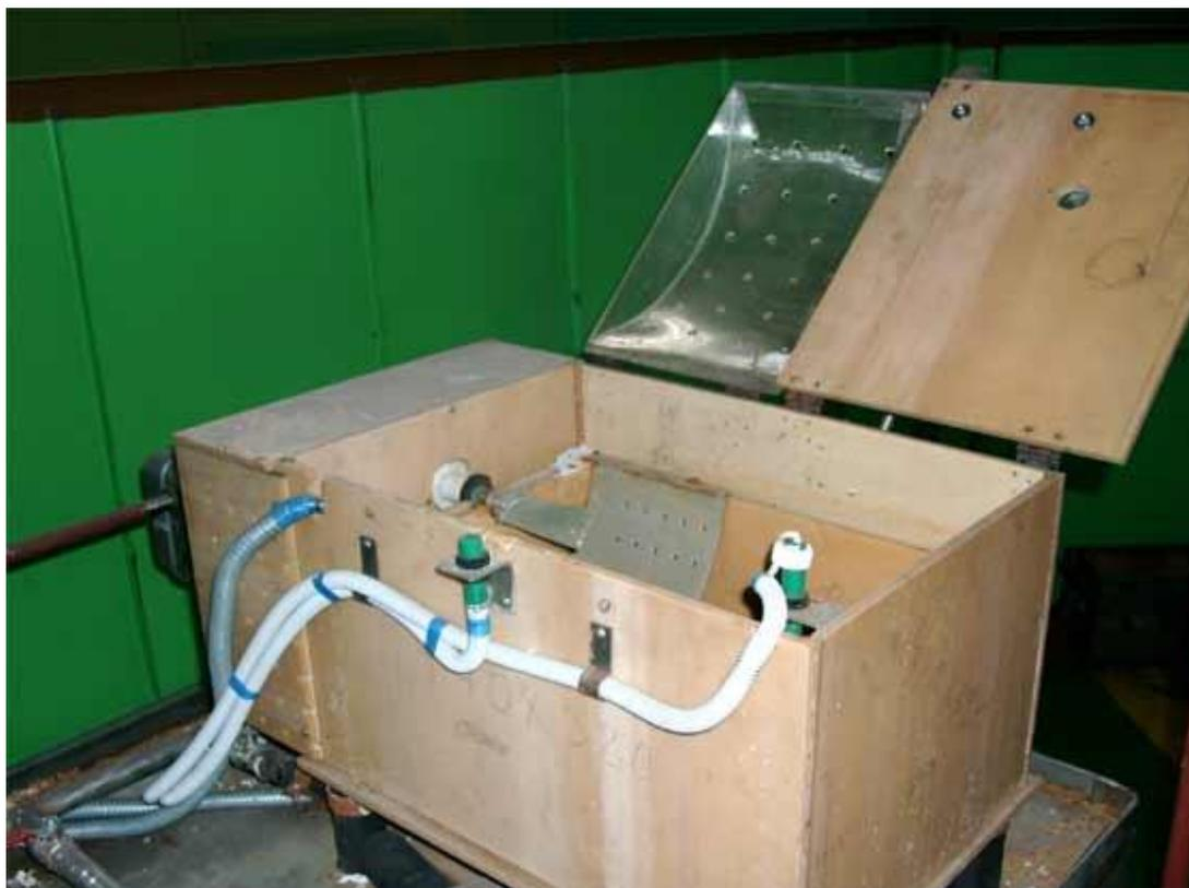
Электролитическая ванна применяется для устранения загрязнений широкой номенклатуры деталей в авиационной, машиностроительной и других отраслях; позволяет за 5-10 секунд обработки солевым раствором под напряжением полностью очистить любую сложнопрофильную деталь, не влияя на ее прочностные и эксплуатационные характеристики.
