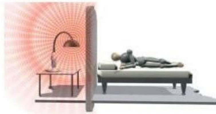
Бетонная стена или перегородка - хорошие преграды для электрического поля
