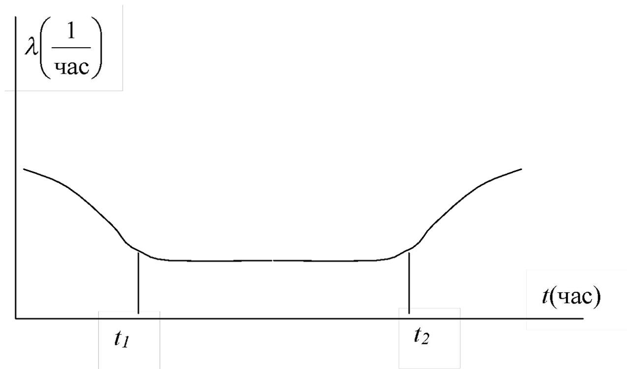
Рис.2. Типичная кривая интенсивности отказов.
