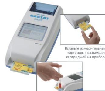
Вставьте измерительный картридж в разъем для картриджа на приборе
