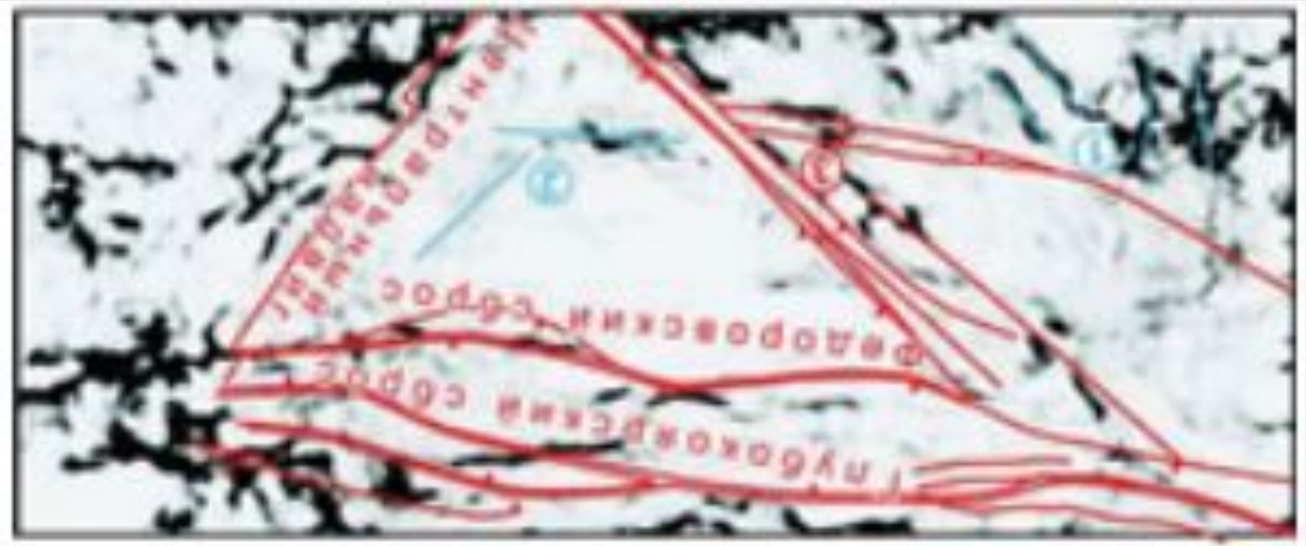
Рис. 9. Срезы когерентности C_{3mm} вдоль отражающего горизонта
