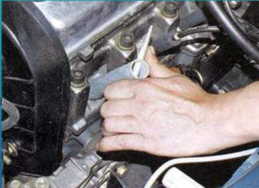
Осмотрите свечи зажигания. Если на изоляторах есть трещины, повреждена резьба или электроды, свечи надо заменить.
