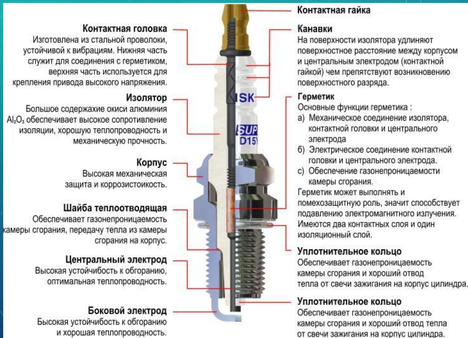
**Свеча зажигания** – это устройство, предназначенное для воспламенения топливно-воздушной смеси с разных типов двигателей.
