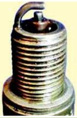
**Фото № 5.** Свеча имеет ярко выраженные следы масла особенно в резьбовой части. Двигатель с такими свечами после длительной стоянки, имеет обыкновение после запуска "троить" некоторое время, а по мере прогрева работа стабилизируется. Причина этого неудовлетворительное состояние маслоотражательных колпачков. Налицо повышенный расход масла. В первые минуты работы двигателя, в момент прогрева, характерный бело-синий выхлоп.
