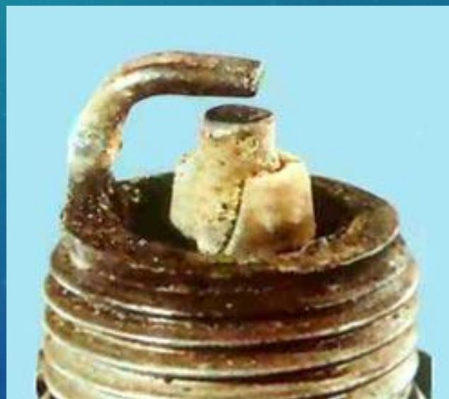
ПРОВЕРЬТЕ ЗАЗОР МЕЖДУ ЭЛЕКТРОДАМИ СВЕЧИ (ТОЛЬКО КРУГЛЫМ ЩУПОМ). ДЛЯ АВТОМОБИЛЕЙ ВАЗ 2108, ВАЗ 2109, ВАЗ 21099 С КАРБЮРАТОРНЫМ ДВИГАТЕЛЕМ ЗАЗОР СВЕЧИ ЗАЖИГАНИЯ ДОЛЖЕН БЫТЬ 0,7-0,85 ММ, А ДЛЯ АВТОМОБИЛЕЙ ВАЗ 2108, ВАЗ 2109, ВАЗ 21099 С ИНЖЕКТОРНЫМ ДВИГАТЕЛЕМ ЗАЗОР СВЕЧИ ЗАЖИГАНИЯ ДОЛЖЕН БЫТЬ -1,00-1,13 ММ. ЕСЛИ ЗАЗОР СВЕЧИ ЗАЖИГАНИЯ ОТЛИЧАЕТСЯ ОТ УКАЗАННОГО, ОТРЕГУЛИРУЙТЕ ЗАЗОР, ПОДГИБАЯ БОКОВОЙ ЭЛЕКТРОД СВЕЧИ.
