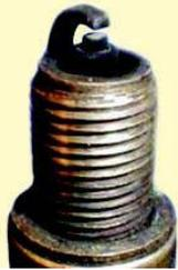
На **фото №2** типичный пример свечи от двигателя с повышенным расходом топлива. Центральный электрод покрыт бархатисто-черным нагаром. Причин тому несколько: богатая воздушно-топливная смесь (неправильная регулировка карбюратора или неисправность инжектора), засорение воздушного фильтра.
