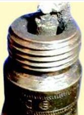
**Фото № 8.** Электрод свечи оброс зольными отложениями, цвет не играет решающей роли, он лишь свидетельствует о работе топливной системы. Причина этого нароста сгорание масла вследствие выработки или залегания маслосъемных поршневых колец. У двигателя повышенный расход масла, при перегазовках из выхлопной трубы сильное, синие дымление, запах выхлопа похож на мотоциклетный.
