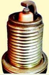
На **фото №1** изображена свеча, вывернутая из двигателя работу которого можно считать *отличной*. Юбка центрального электрода имеет светло-коричневый цвет, нагар и отложения минимальны. Полное отсутствие следов масла.
