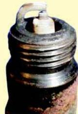
На **третьем фото** наоборот пример чрезмерно бедной воздушно-топливной смеси. Цвет электрода от светло-серого до белого. Езда на слишком обедненной смеси и при повышенных нагрузках может стать причиной значительного перегрева, как самой свечи, так и камеры сгорания, а перегрев камеры сгорания прямой путь к прогару выпускных клапанов
