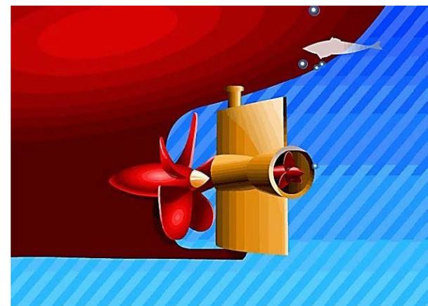
Для повышения упора гребных винтов и улучшения управляемости судна используются *поворотные направляющие насадки* – ПН.
