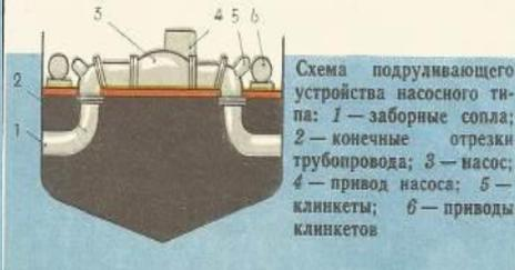
Схема подруливающего устройства насосного типа: 1 — заборные сопла; 2 — конечные отрезки трубопровода; 3 — насос; 4 — привод насоса; 5 — клинкет; 6 — приводы клинкетов
