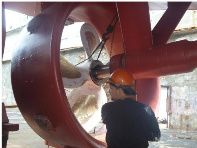
*Подруливающие устройства (ПУ) – дополнительный орган управления обеспечивает управляемость судна при отсутствии хода или малой скорости движения судна. Двигатель располагается в поперечном тоннеле, в корпусе судна ниже ватерлинии и обеспечивает поперечный упор.*
