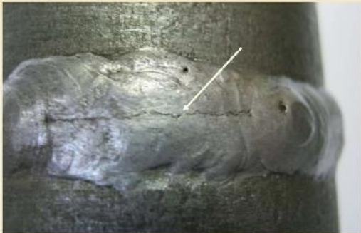
Продольная трещина сварного соединения.
