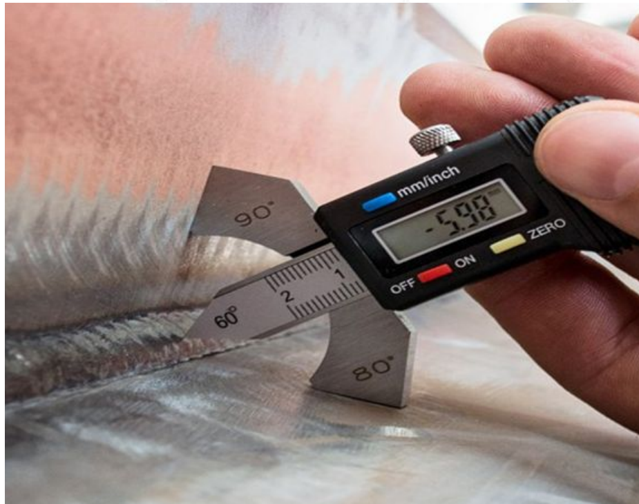
Измерение высоты стыкового сварного шва
