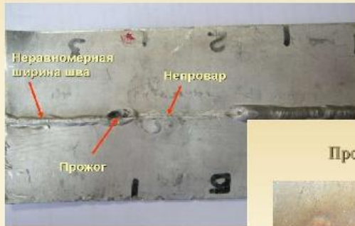
Дефекты сварных соединений.
