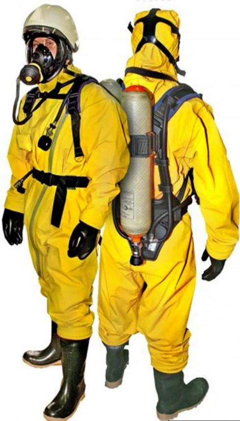
Предназначен для индивидуальной комплексной защиты человека при проведении аварийно-спасательных работ в зоне сочетанного бета-гамма облучения, особенно в помещениях малого объёма с мощными стенками, в частности, на гражданских и военных судах с ядерными силовыми установками. Дыхательный аппарат со сжатым воздухом надевается поверх костюма, что позволяет увеличивать время работы за счет возможности быстрой смены баллонов.
