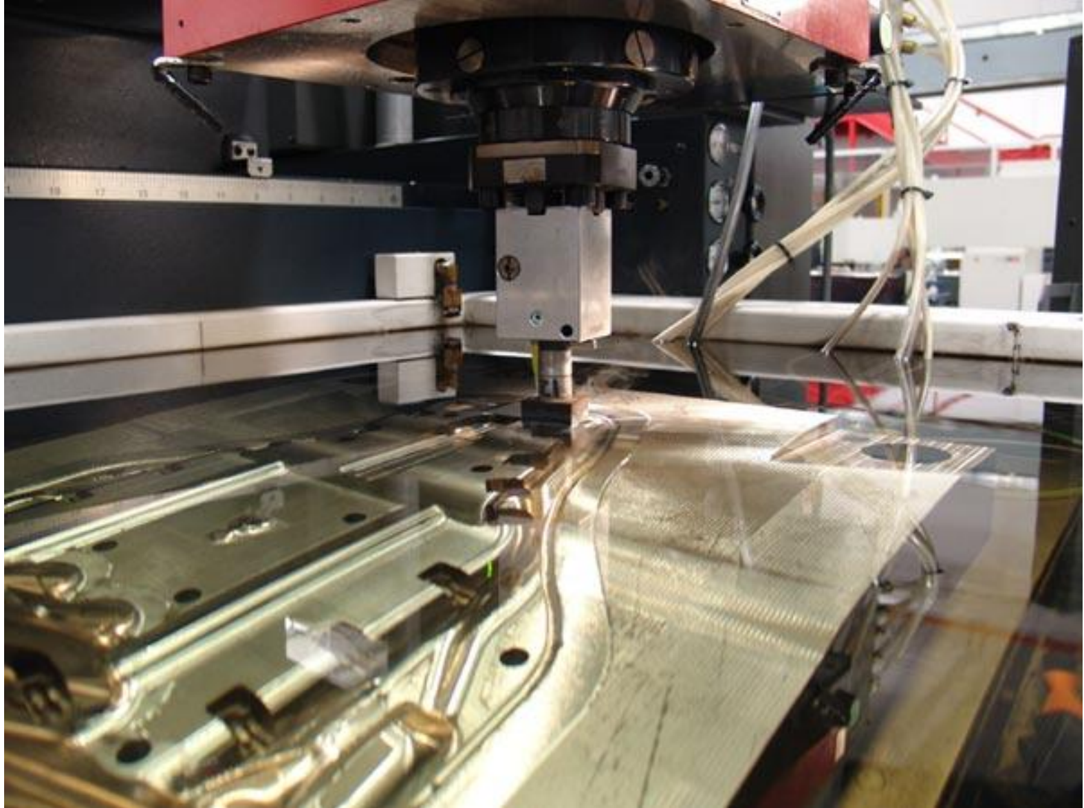
Станок электроэрозионной обработки в действии. Обрабатываемая деталь погружена в жидкость.
