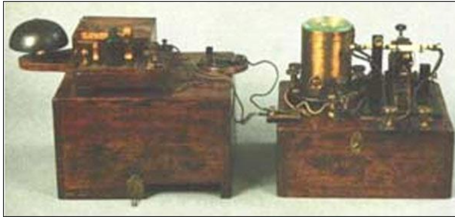
Система радиосвязи А. С. Попова
