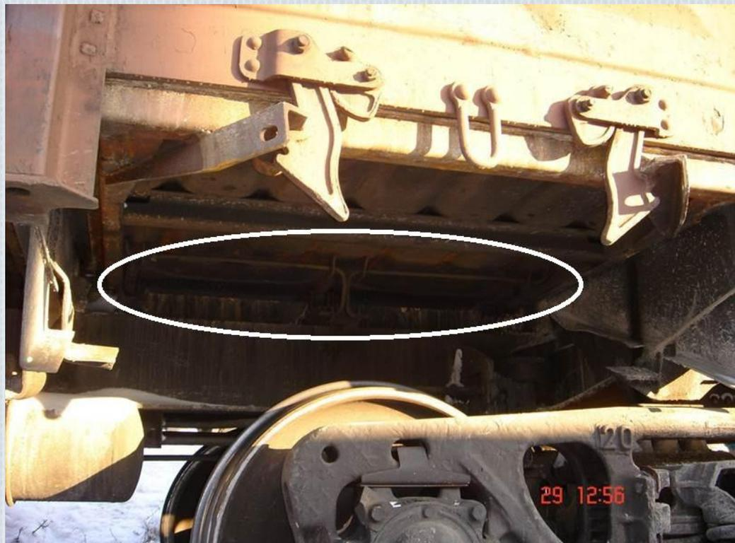
При открытии запоров крышка под действием массы груза падает вниз и закручивает торсион, в результате чего в нём появляется упругое напряжение и силы реакции стремятся поднять крышку вверх в горизонтальное положение.
