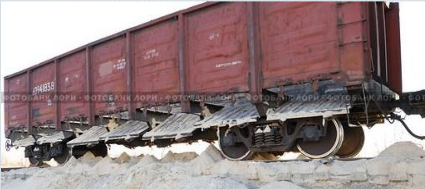
В полу кузова, вдоль боковых стен, предусмотрены разгрузочные люки, через которые сыпучий груз самотеком разгружается по обе стороны полувагона. Погрузку в полувагон длинномерных грузов и самоходного транспорта осуществляют через двери.
