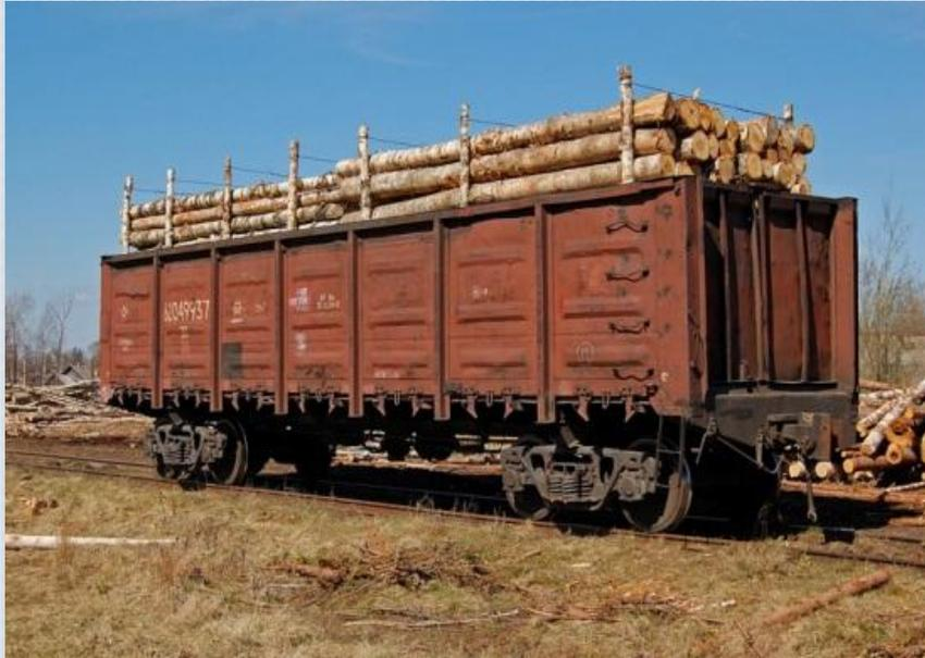
Данный железнодорожный вагон предназначен для транспортировки насыпных, непылевидных, навалочных, штабельных и штучных грузов, которые не требуют особой защиты от атмосферных осадков.
