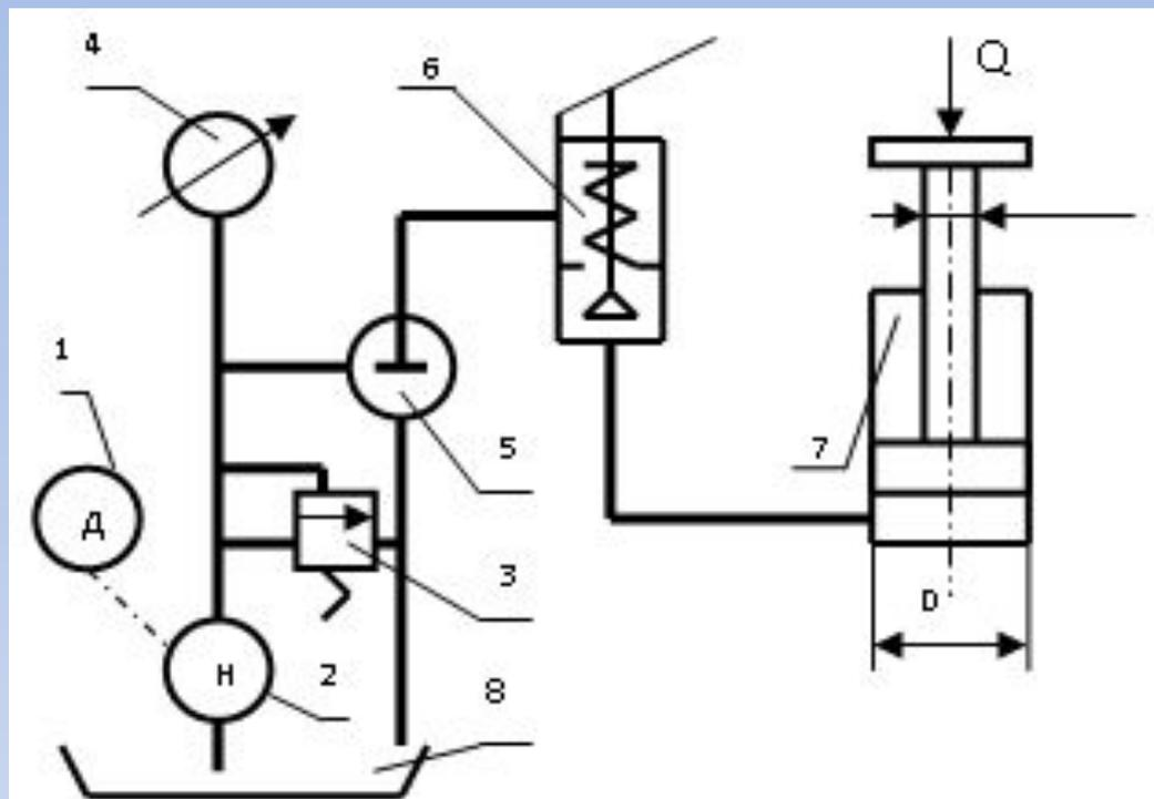
**Рисунок 1. Гидравлическая схема простейшего подъемника:** 1.Привод насоса (двигатель). 2.Насос. 3. Предохранительный клапан. 4. Манометр. 5. Кран. 6. Клапан перепускной. 7. Гидроцилиндр (поршень). 8.Гидробак
