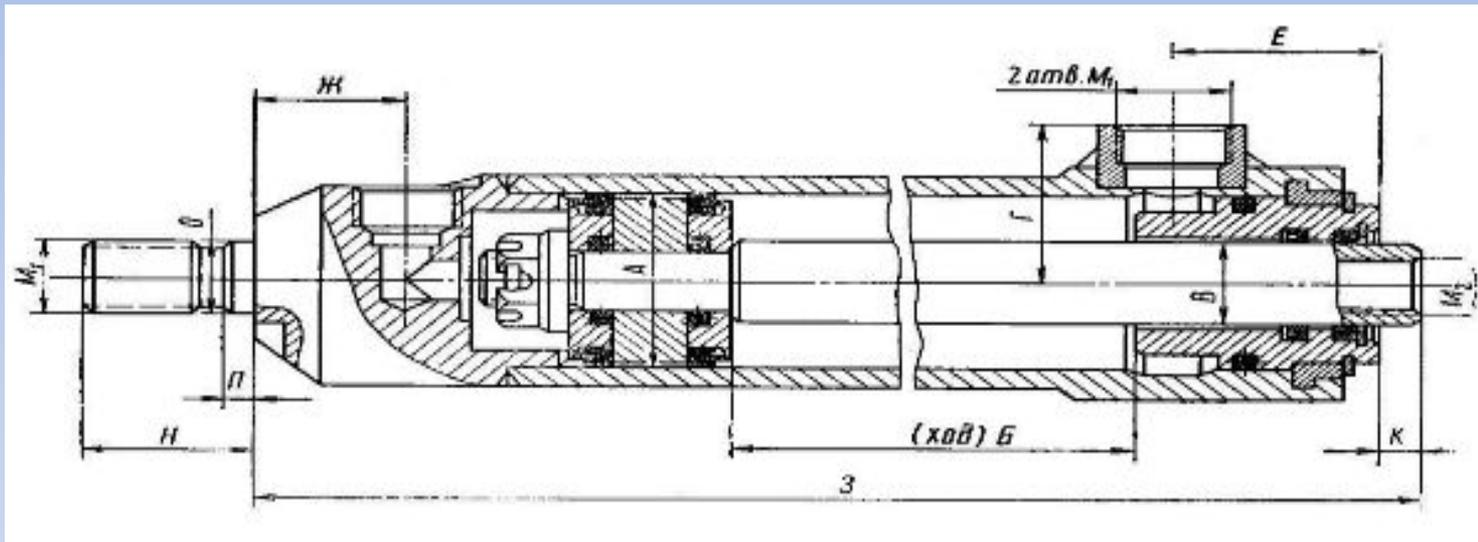
Рисунок.2. Гидроцилиндр Ц2001.
