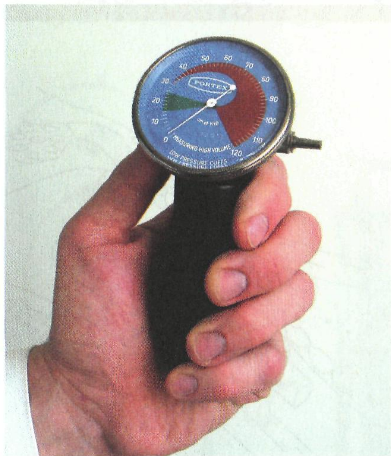
Рис. 21. Манометр для измерения давления в манжете. Зеленая зона соответствует давлению, при котором ишемические повреждения слизистой оболочки трахеи минимальны.
