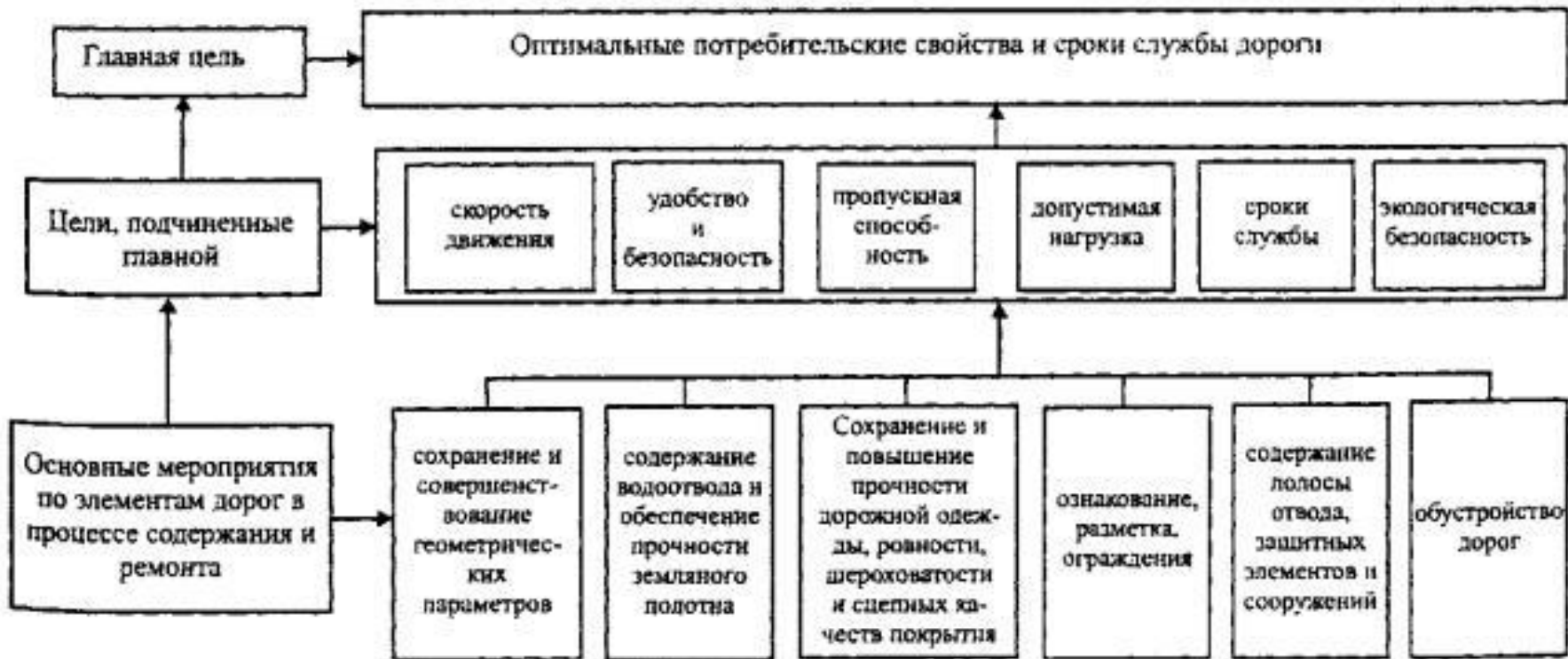
Укрупненная схема целей и задач планирования работ по содержанию и ремонту дорог
