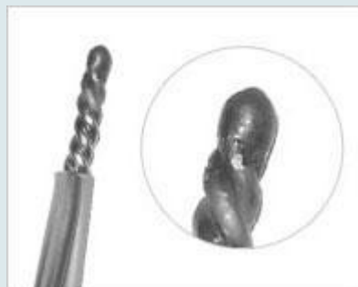
Рисунок. Сварка скрутки.
