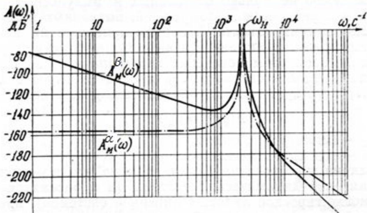
Рис. 4.3. Амплитудно-частотные характеристики трехстепенного гироскопа без затухания
