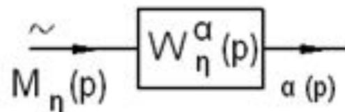
Т. к. система линейна, то после окончания переходного процесса на выходе устанавливаются колебания той же частоты, что и на входе; амплитуда и фаза определяются АЧХ и ФЧХ.
