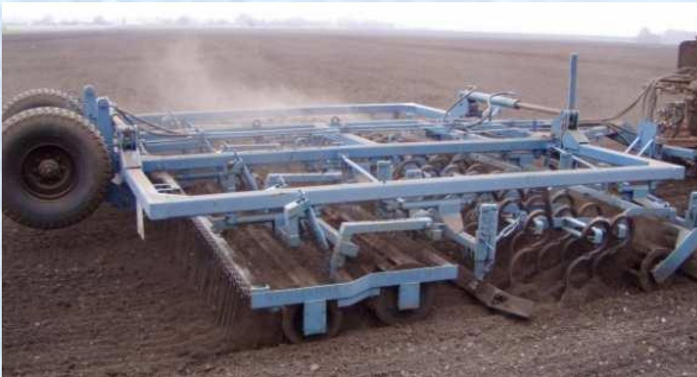
Культиватор Орикон-К6 предназначен для сплошной предпосевной обработки почвы всех видов. За один проход культиватор КППШ-6 выполняет четыре основных операции: рыхление, выравнивание, разрушение глыб, уплотнение посевного слоя почвы. Совмещение технологических операций в культиваторе КППШ-6 позволяет сократить затраты, сократить время проведения работ, повысить качество обработки почвы.
