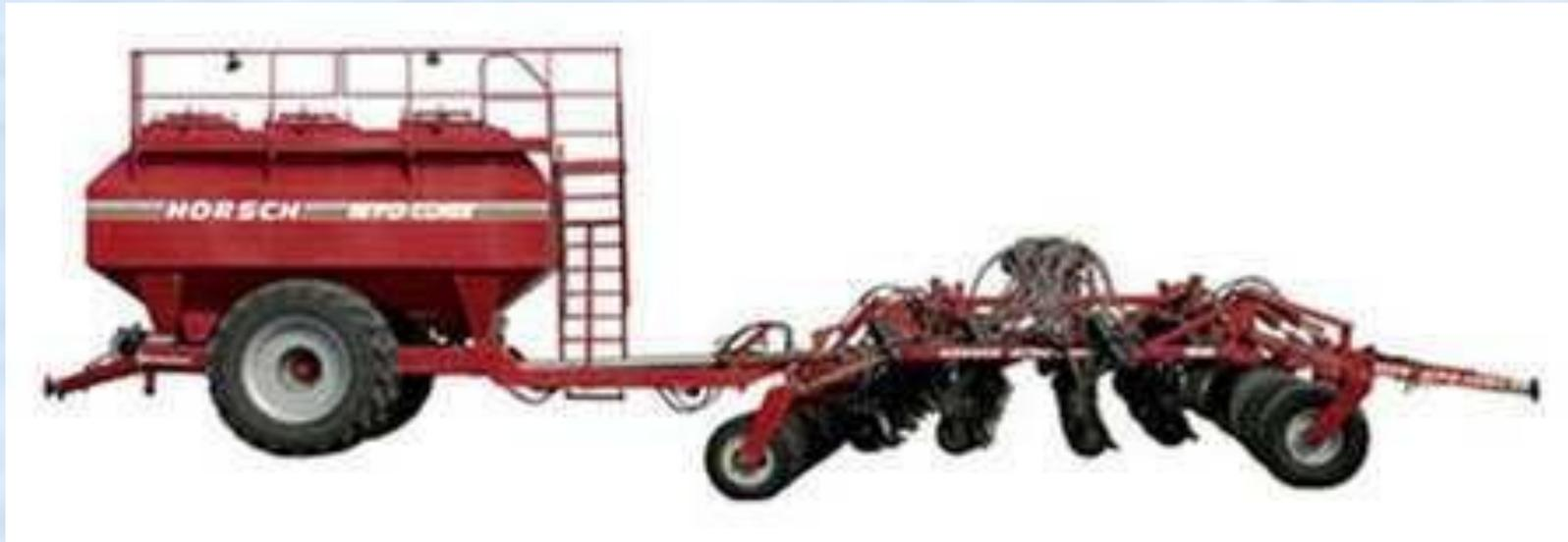
Посевной комплекс «Horsch – Агро-Союз» может осуществлять за один проход посев без предварительной обработки почвы, внесение сыпучих и жидких удобрений точно под горизонт посева и прикатывание.
