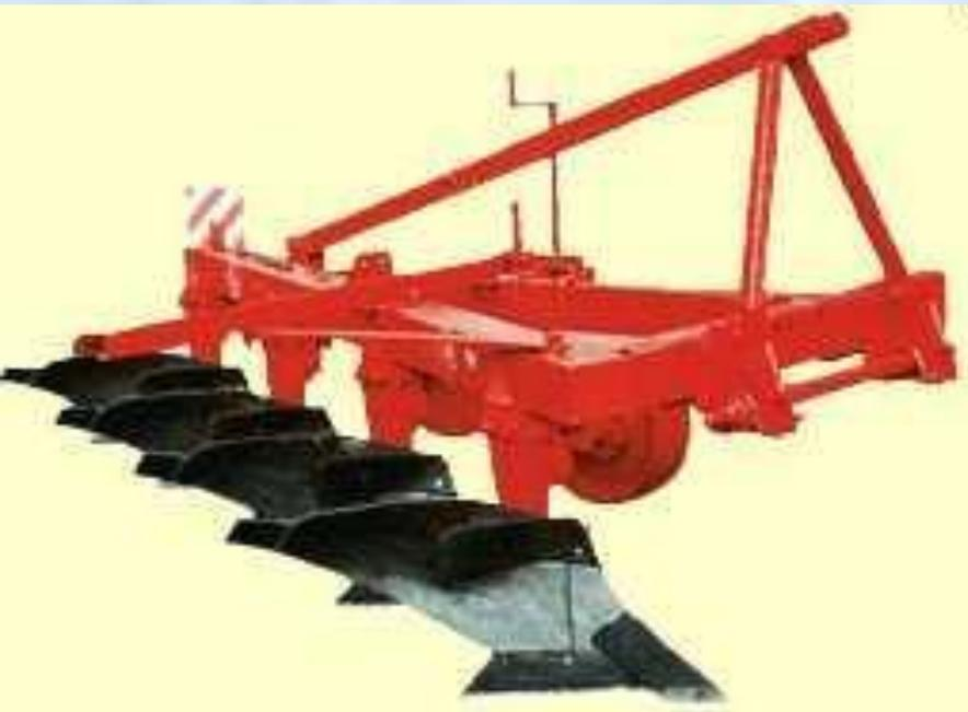
**Вари-Диамант 9 5N 100** - пятикорпусной оборотный плуг с регулируемой шириной захвата от 30 до 55 см. Защита от перегрузок при помощи срезных болтов, пружин.
