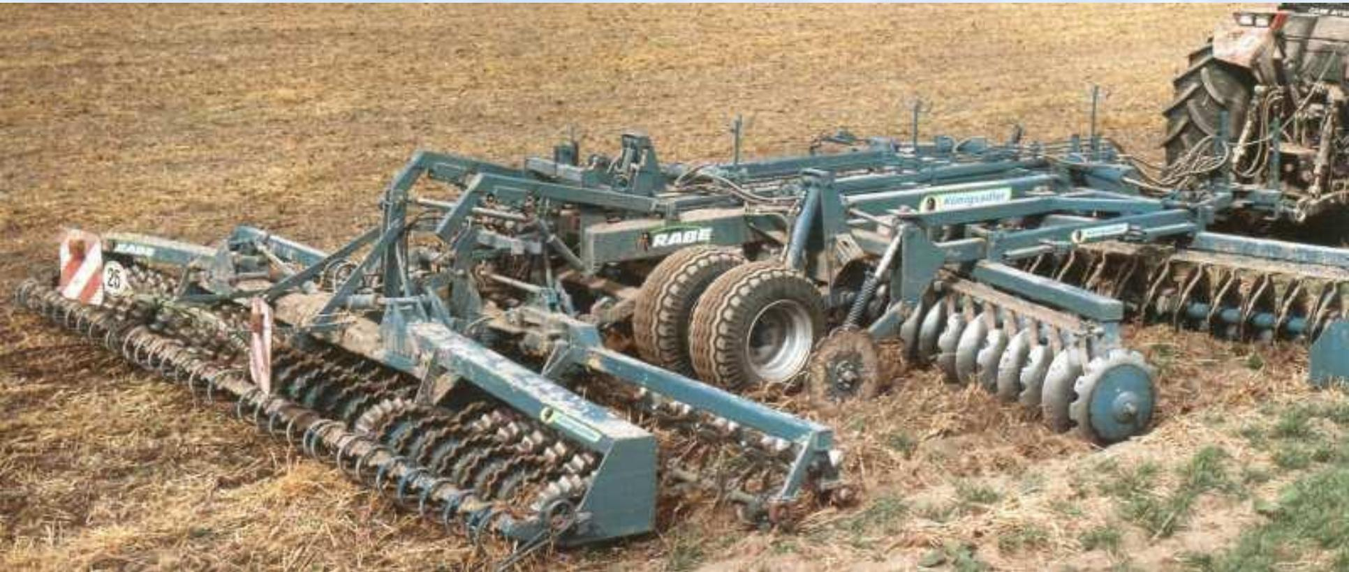
Предназначена для неглубокого и глубокого рыхления с интенсивным измельчением, перемешиванием растительных остатков и последующим уплотнением почвы.
