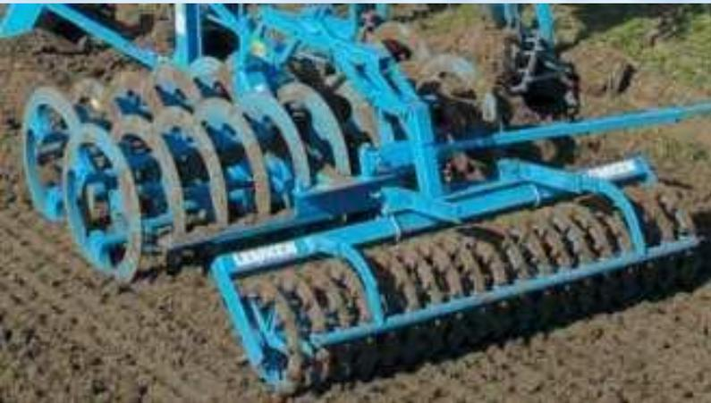
Каток для любых почвенных условий используется в комбинации с плугом фирмы Lemken. После прохода прикатывающих катков ВариоПак восстанавливаются капиллярные каналы в корнеобитаемом слое, а крупные комки дополнительно крошатся. Последствие катков предотвращает высыхивание почвы и активизирует действие почвенных микроорганизмов.
