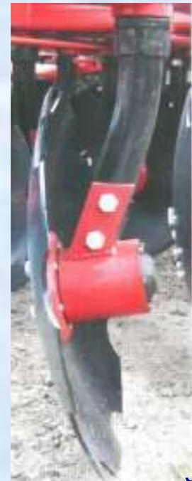
Отличительной особенностью дискатора является то, что каждый диск установлен на индивидуальной стойке и имеет наклон от вертикальной оси. Диск выполняет роль лемеха и отвала. Угол атаки настраивается от 0 до 30 градусов. Работают дискаторы в условиях повышенной влажности на полях с большим количеством растительных остатков. Один проход дискатора = 3 проходам дисковой бороны.
