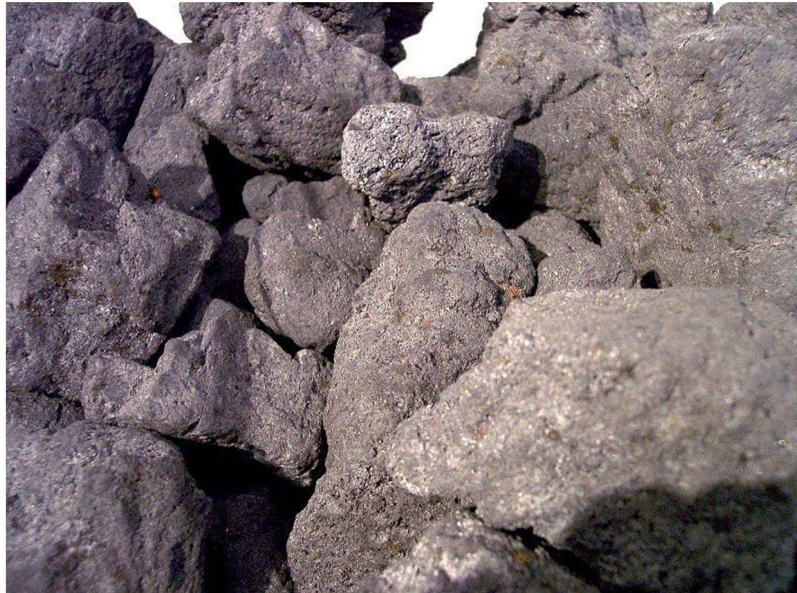
Полукоксование — способ переработки твёрдых топлив (каменного и бурого углей, сланцев, торфа) нагреванием без доступа воздуха до 500—550 °С (температура приблизительно вдвое ниже, чем при коксовании). При полукоксовании получают твёрдый горючий остаток — полукокс и летучие продукты. Полукокс используют как легко загорающееся бездымное твёрдое топливо в промышленности и быту.
