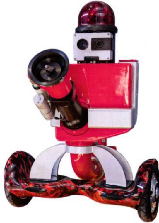
Общий вид мобильного пожарного робота на гироскутере
