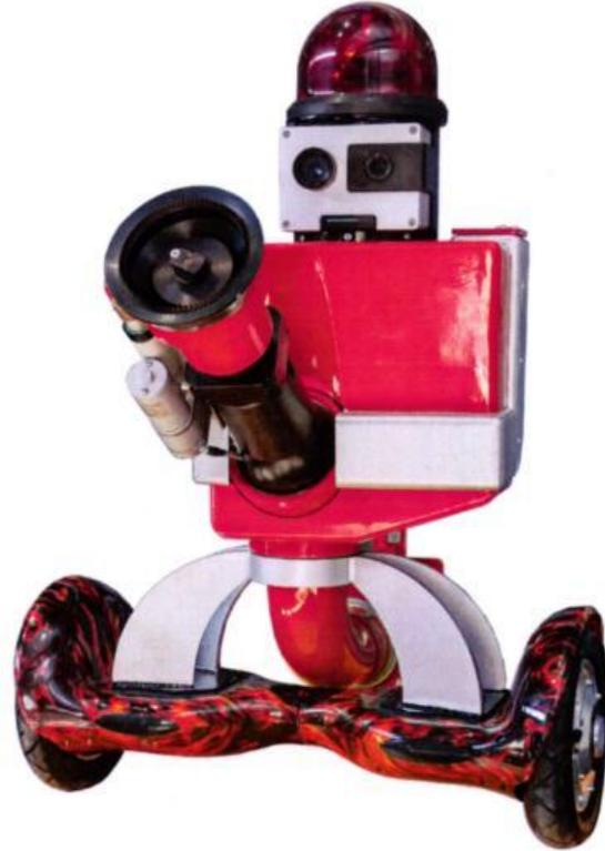
Общий вид мобильного пожарного робота на гироскутере
