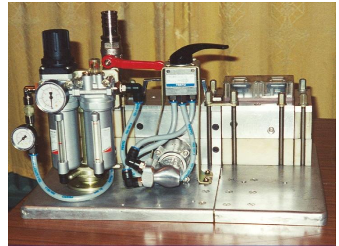
Инжектор ПСИ-1 для задувки кабеля.
