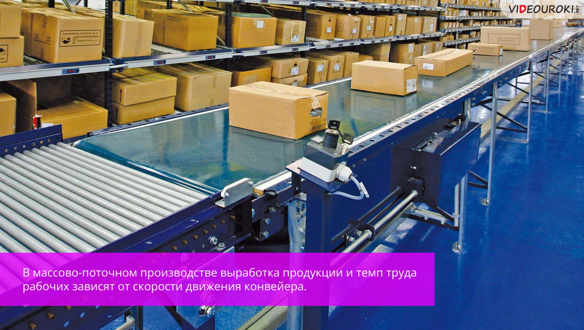
В массово-поточном производстве выработка продукции и темп труда рабочих зависят от скорости движения конвейера.
