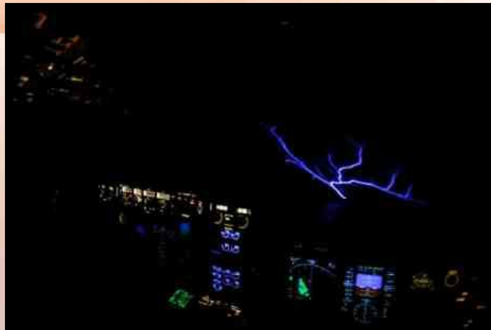
Огни святого Эльма на ветровом стекле кабины пилотов самолета-заправщика KC-10 Extender Фото: ВВС США
