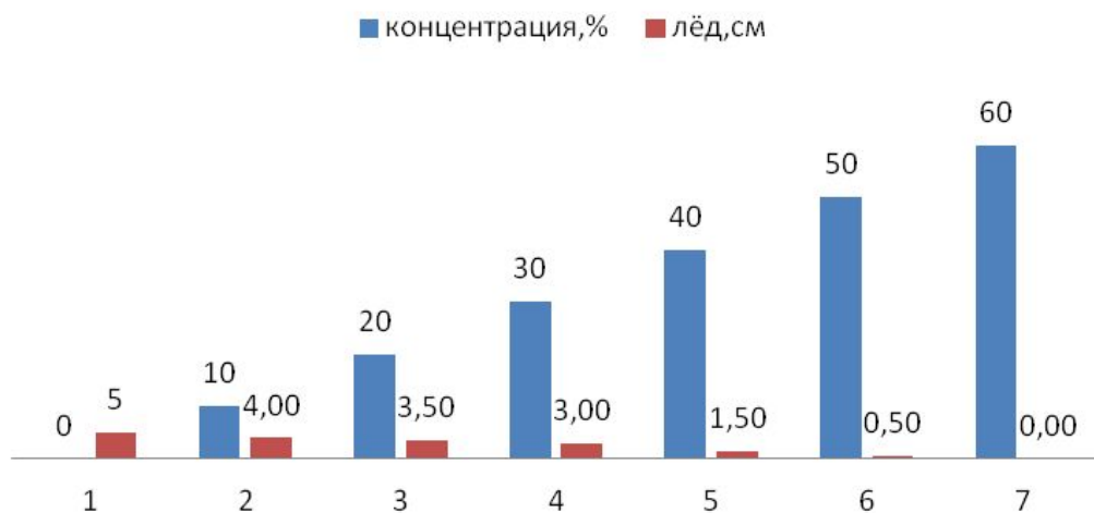
Рисунок 1. Зависимость замерзания раствора от концентрации глицерина
