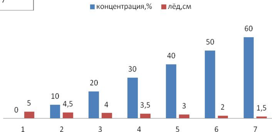
Рисунок 2. Замерзание растворов глюкозы различной концентрации
