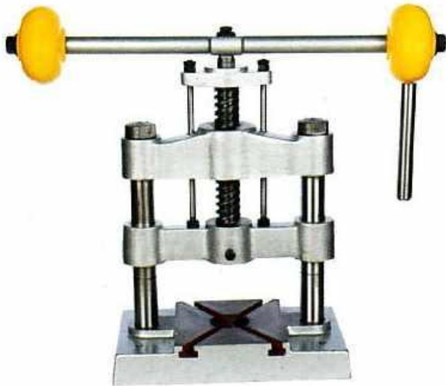
Испытания образца породы на винтовом прессе
