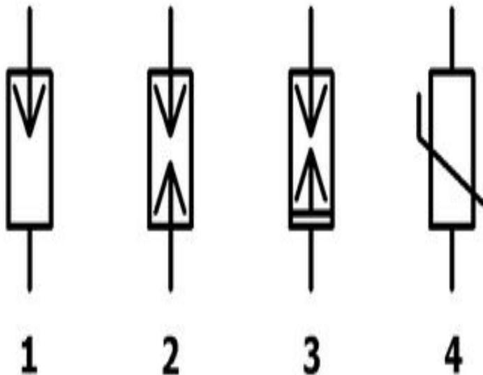
На электрических принципиальных схемах разрядники обозначаются
