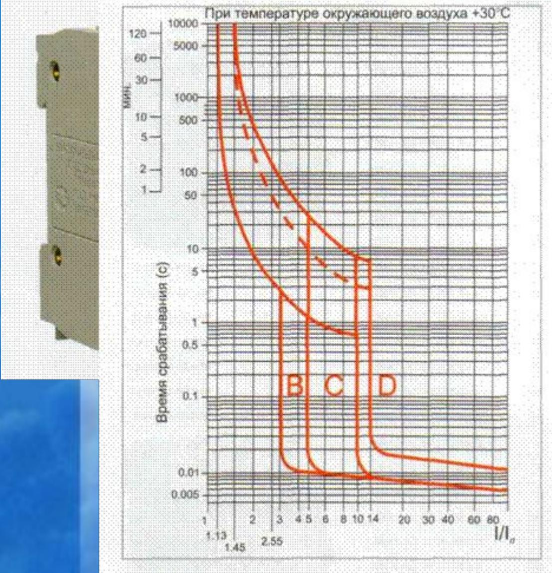
Максималды ток қорғанысының негізгі артықшылышының бір көршілес қорғаныс әсерін резервтеу болып табылады. Қорғаныстың бірі істен шыққан жағдайда, қысқаша түйікталуды сөндіру қоректендіру көзіне жақын орналасқан көршілес қорғаныс арқылы жүзеге асады. Қорғаныстың негізгі кемшілігі – қоректендіру көзіне жақын қысқаша түйікталу кезіндегі тым көп уақыт тоқтатылуы, ол құрделі тарату тораптарында қорғанысты қолдану мүмкіншілігін шектейді.
