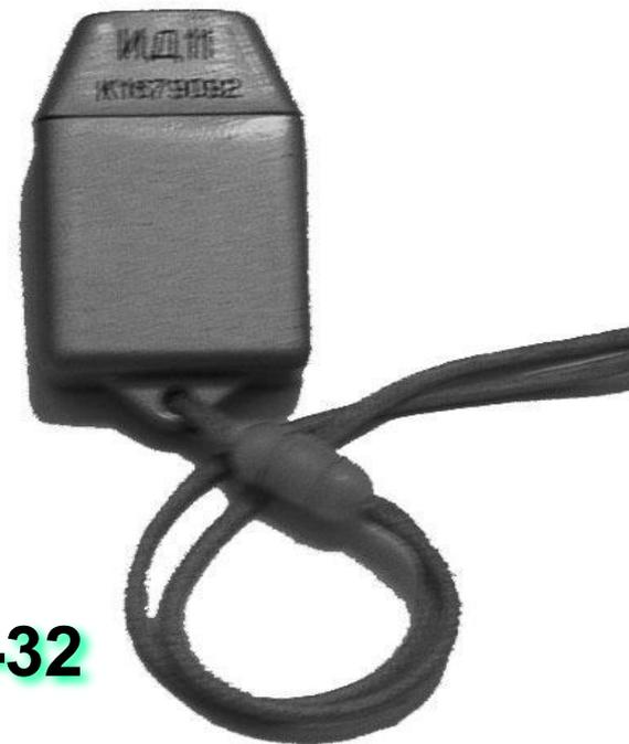
Индивидуальный измеритель дозы ИД-11 предназначен для индивидуального контроля облучения личного состава, подвергшегося воздействию ионизирующего излучения.
