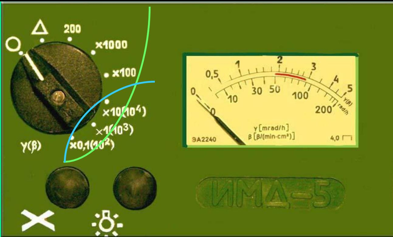
2. Прибор обеспечивает индикацию плотности потока бета-излучения в пределах от 50 до 50000 бета частиц МИН. СМ<sup>2</sup>
