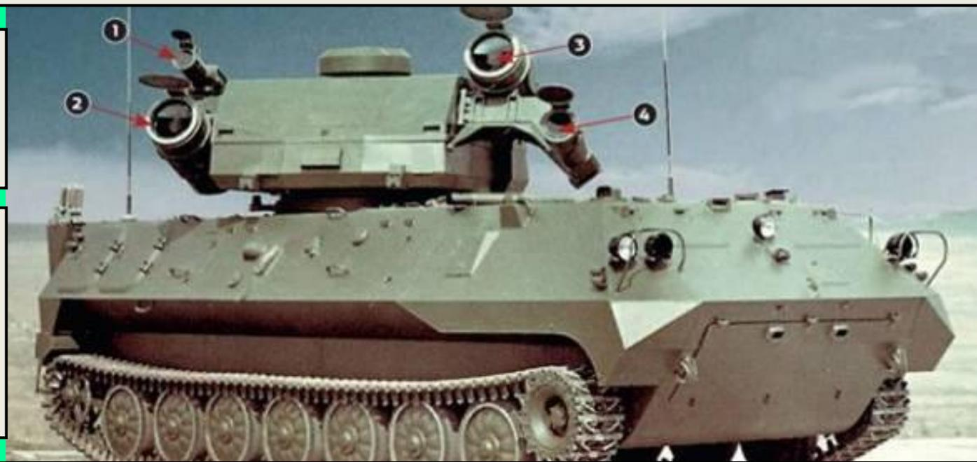
Система размещена на гусеничном плавающем самоходном шасси;
