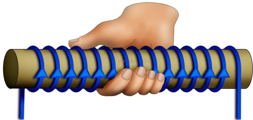
**Правило буравчика:** если поворачи-вать головку винта так, чтобы посту-пательное движение острия винта происходило вдоль тока в проводни-ке, то направление вращения голов-ки указывает направление линий магнитного поля тока.
