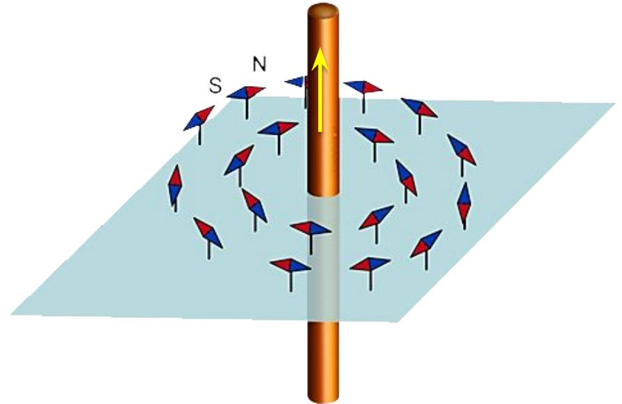
Направление линий магнитного поля будет зависеть от направления тока в проводнике
