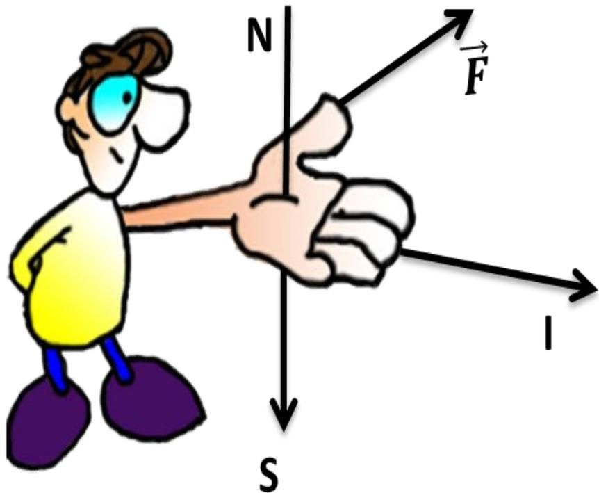
**Правило левой руки:** если левую руку расположить так, чтобы линии магнитного поля входили в ладонь перпендикулярно к ней, а четыре вытянутых пальца были направлены по току, то отставленный на  $90^\circ$  большой палец покажет направление действующей на проводник силы.
