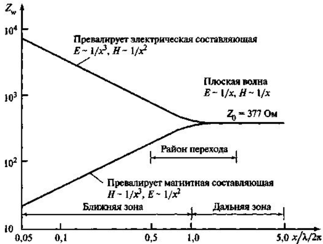
Рис. 2.16. Волновое сопротивление Z_w в функции расстояния x/(\lambda/2\pi) от источника
