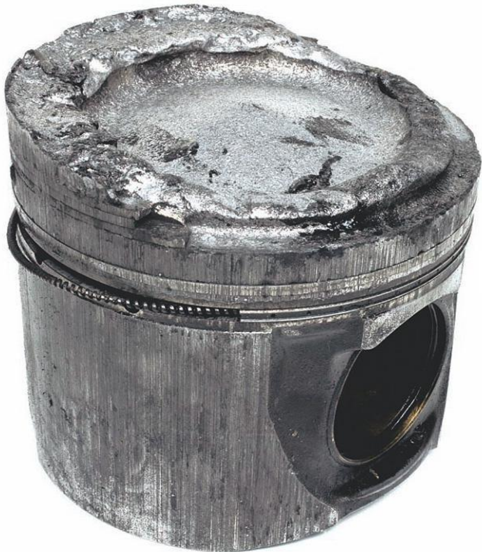
Рис. 2 Расплавленная головка поршня дизельного двигателя
