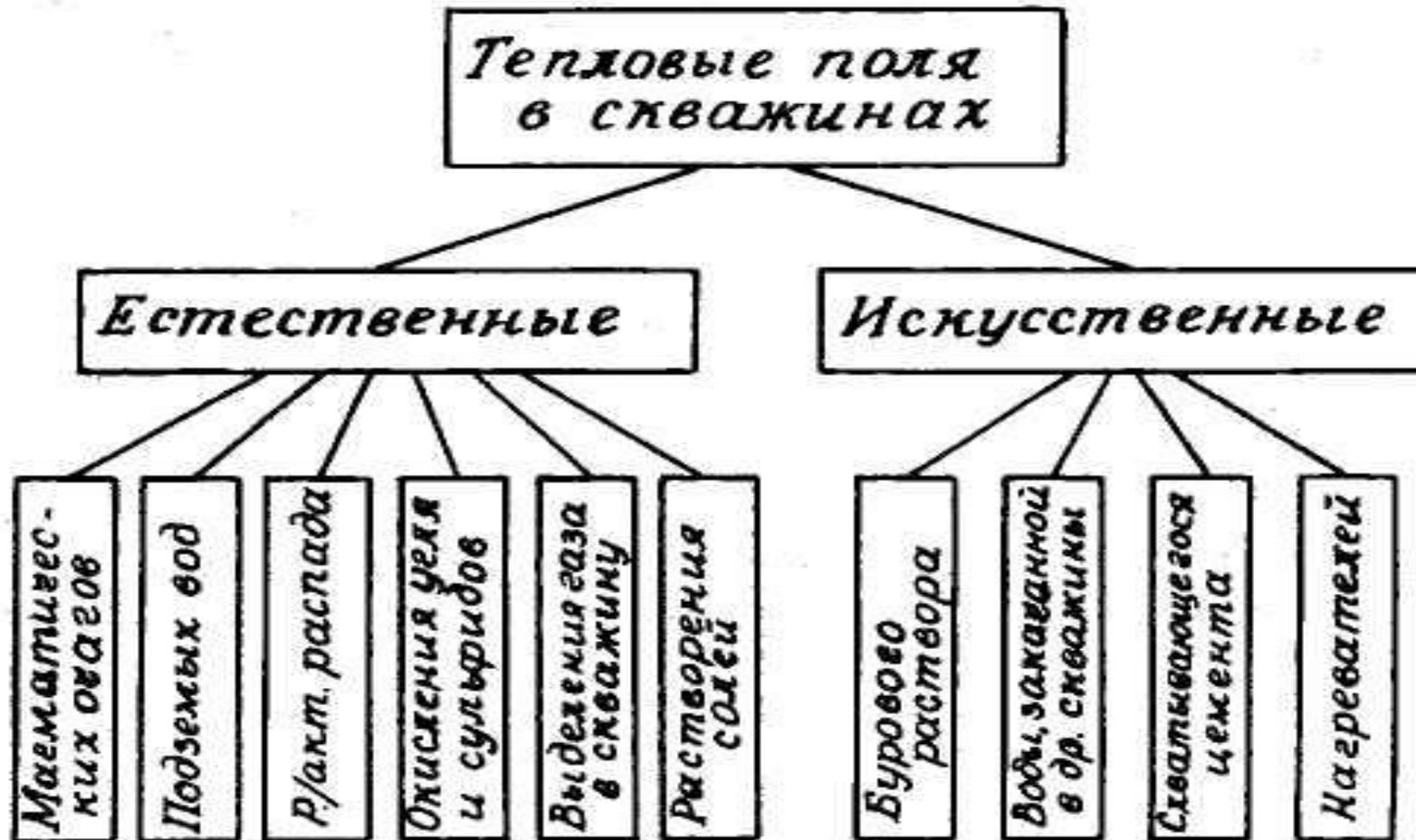
Температурные измерения могут проводиться в *установившемся* или *неустановившемся* тепловом режиме скважины. При **установившемся режиме** температура бурового раствора не отличается от температуры стенок скважины, т. е. теплообмен между ними уже закончен.
