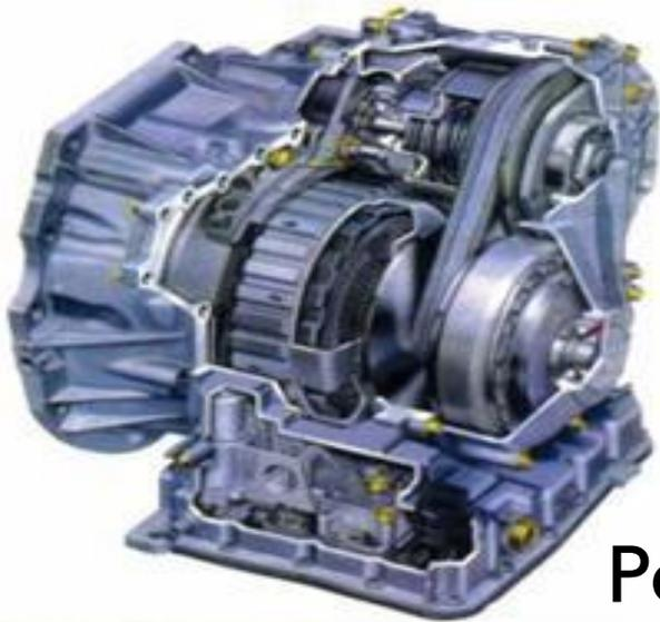
Регулирование передаточного числа вариатора осуществляется по угловой скорости и нагрузке центробежным и вакуумным регуляторами.
