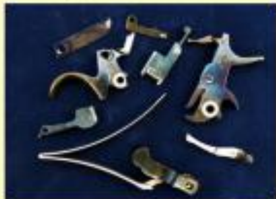
Цвета побежалости при термообработке стали
