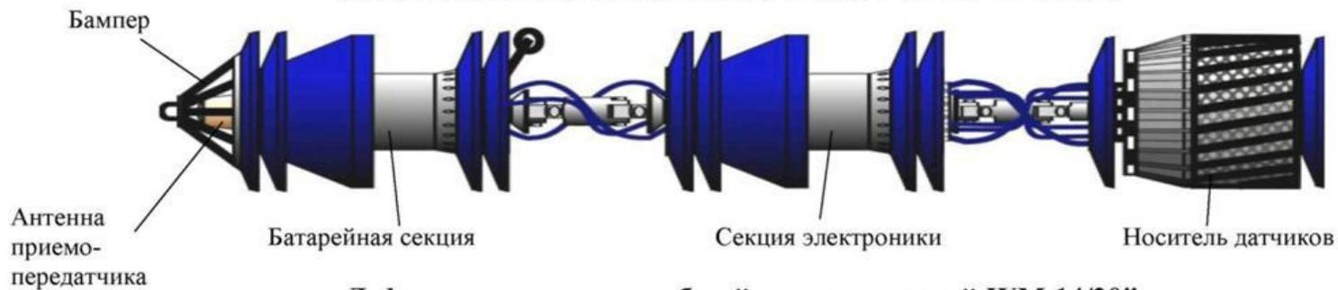
Дефектоскоп внутритрубный ультразвуковой WM 14/20"
