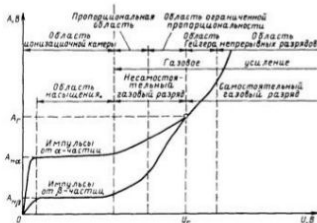
Рис. 5.4 Зависимость амплитуды импульса A от напряжения U для различных режимов работы импульсного ионизационного детектора
