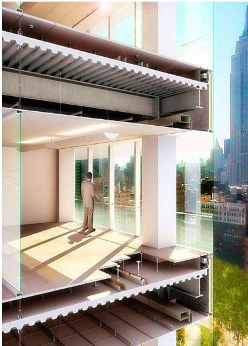
При шаге несущих конструкций 7,5 м применяются ребристые монолитные железобетонные перекрытия по профилированному настилу со стержневой арматурой. Толщина перекрытия составляет 150 мм.
