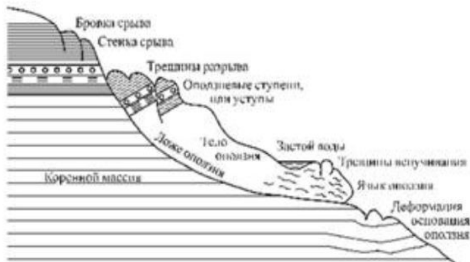
Рис. 2.10. Схема образования оползня
