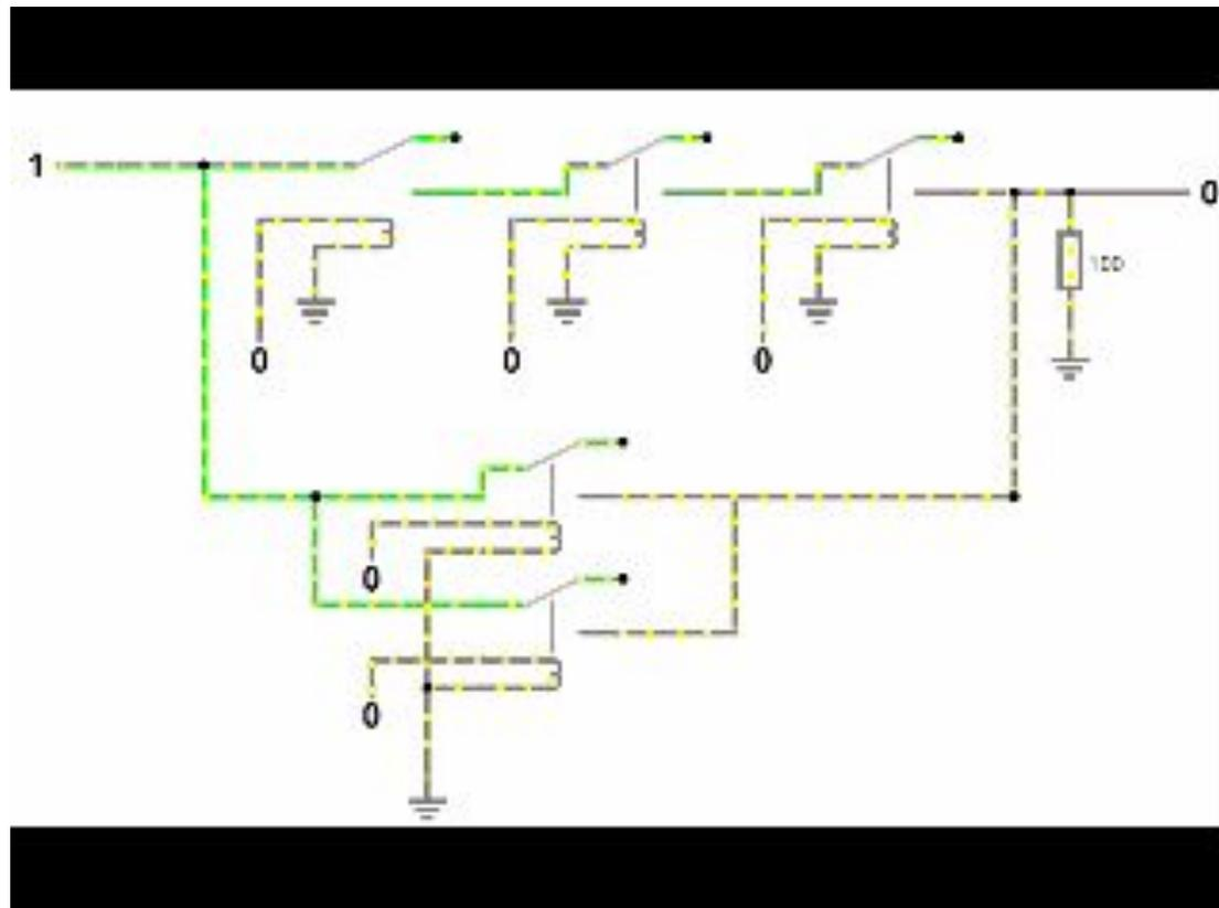
*Переключатель* - электромагнитное реле с контактами и индукционной катушкой, состояние которой моделируется пропозициональной переменной  $X$ :  $X=1$  - в катушке идет ток, и  $X=0$  - в катушке тока нет.
