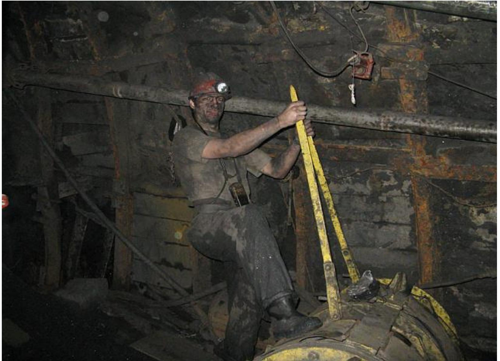
Достоинствами скреперных установок являются совмещение операций по погрузке и доставке, простота конструкции, надежность работы в сложных условиях, возможность транспортирования крупнокусковых скальных пород и работы при различных углах наклона трассы, простое изменение длины доставки, невысокая стоимость. Недостатки скреперных установок: малая производительность, ограниченная длина транспортирования, быстрый износ канатов, высокая энергоемкость.
