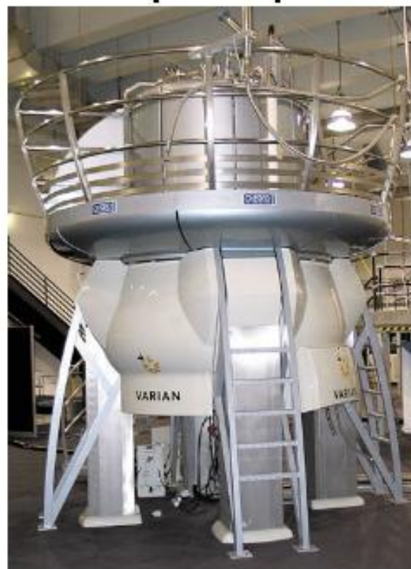
Магнит спектрометра ЯМР на 900 МГц
