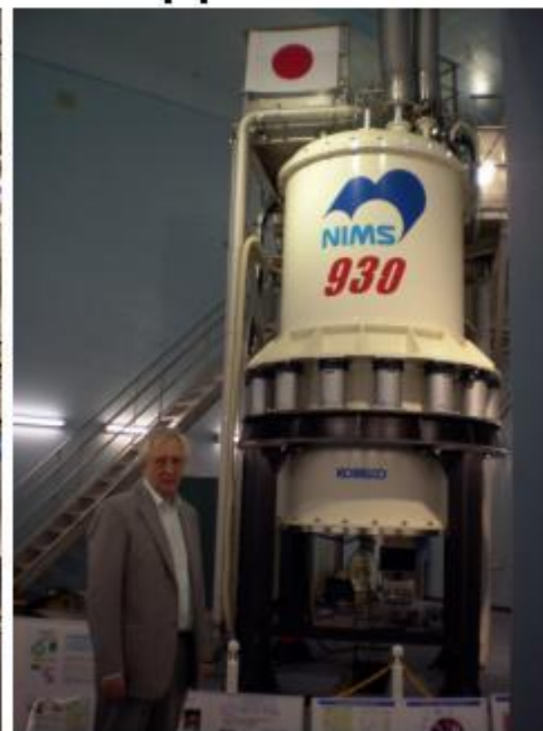
Магнит спектрометра ЯМР на 930 МГц
