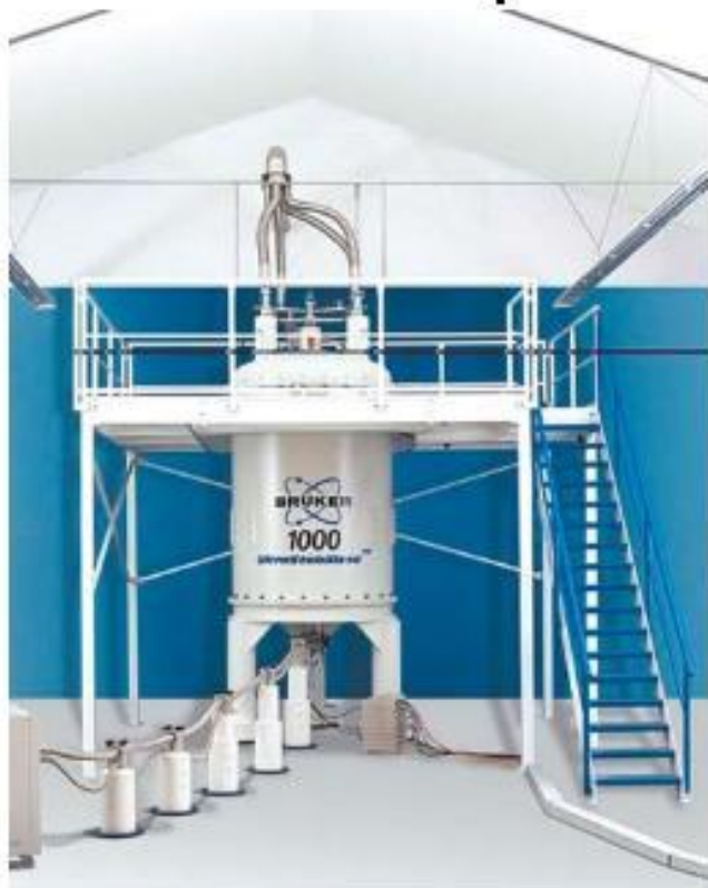
Магнит спектрометра ЯМР на 1000 МГц
