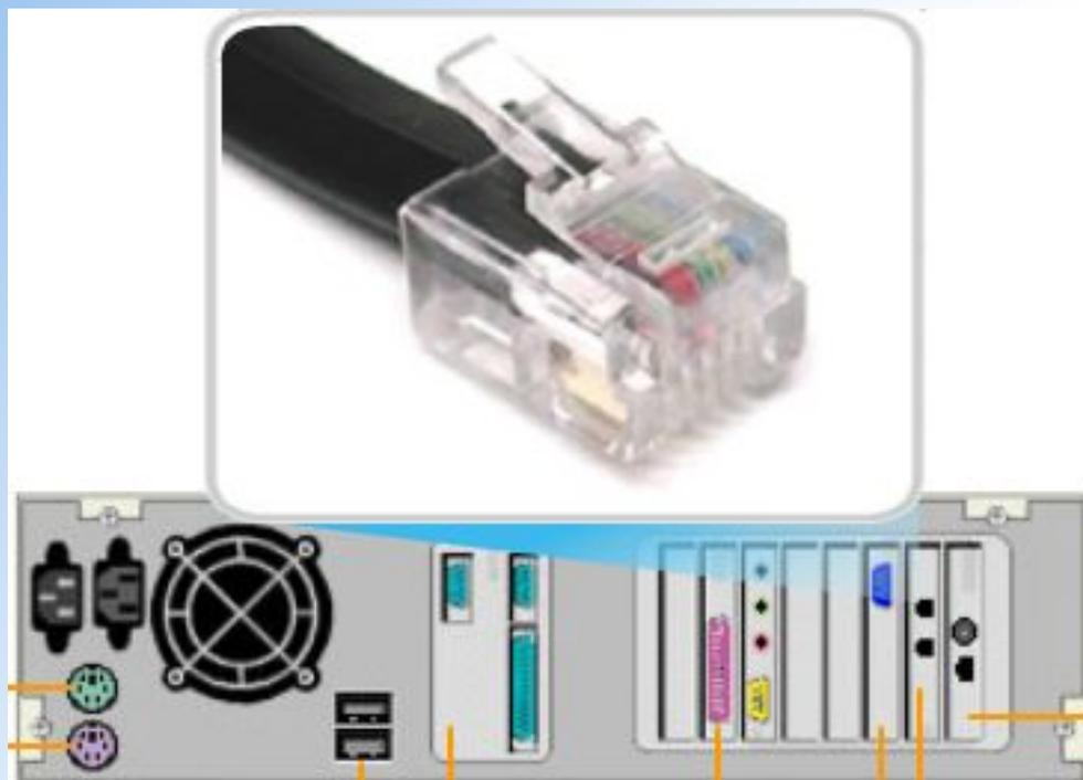
Разъем RJ-11 используется телефонными компаниями по всему миру в различных отраслях промышленности. Разъем такого типа используется в модеме для подключения компьютера к телефонной линии связи.
