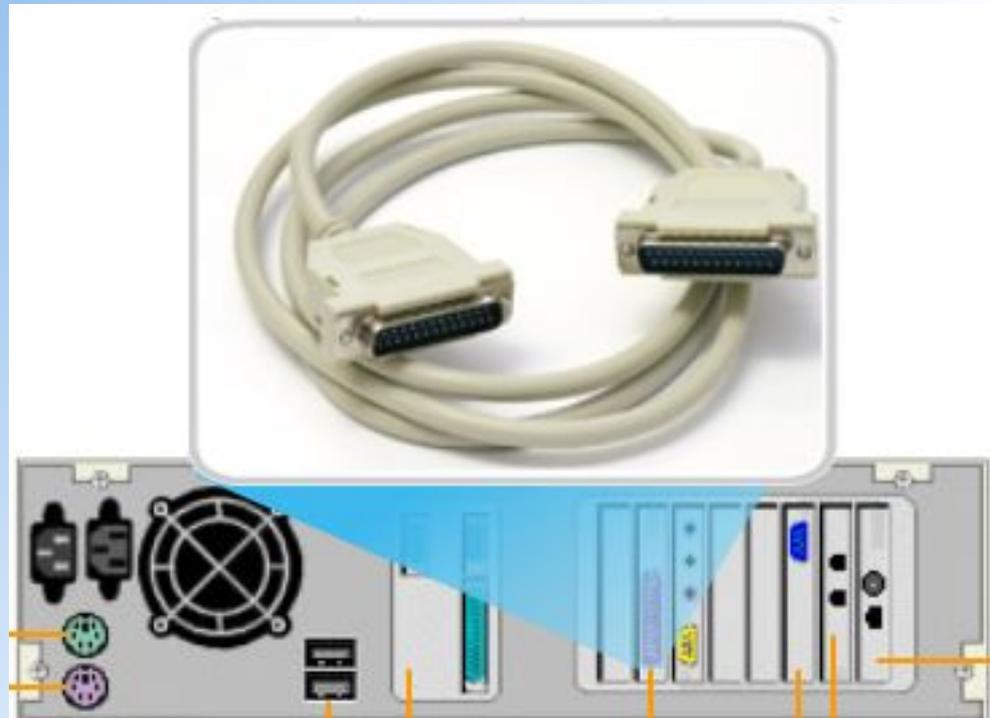
Параллельный порт изначально предназначался для связи компьютера с принтером. Он представляет собой 25-штырьковый разъем гнездового типа. Параллельные порты обычно используются для связи локального компьютера с принтерами, внешними устройствами записи, накопителями на магнитной ленте, CD- или DVD-дисководами. Этот порт можно использовать для соединения двух компьютеров с целью обмена данными между ними.
