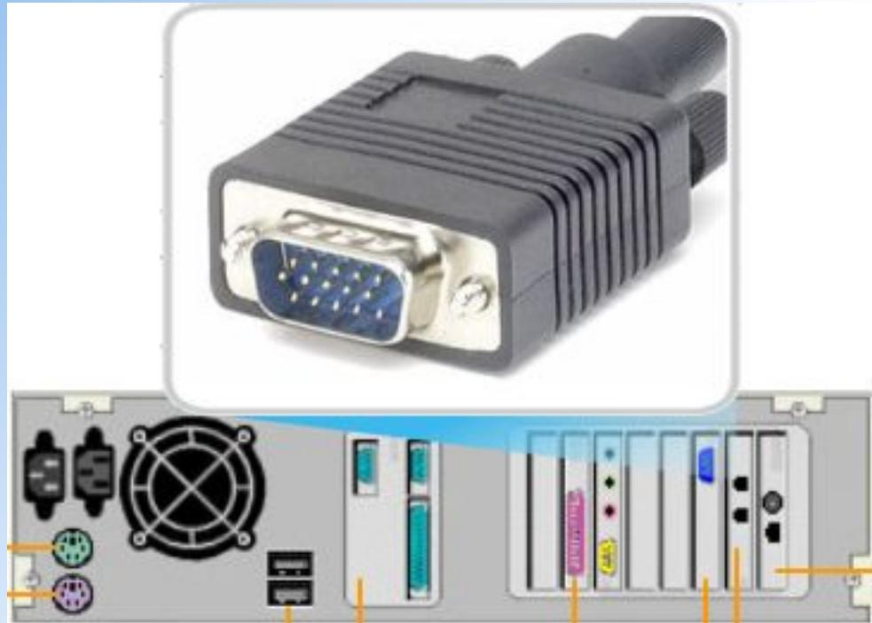
15-штырьковый видеоразъем является стандартным оборудованием персонального компьютера. Он используется для подключения мониторов с матрицей VGA или SVGA. В большинстве персональных компьютеров используется разъем DB15 (совместимый с видео высокой четкости (HD)), имеющий три ряда по 5 штырьков.
