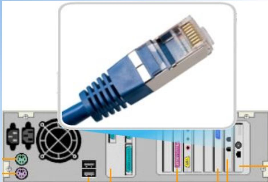
Разъем RJ-45 - стандартный разъем, использующийся для сетей Ethernet. Разъем данного типа используется для подключения компьютера к локальной сети (LAN) или к внешнему модему, например, к модемам, которые предоставляются Интернет-провайдерами, организующими высокоскоростные соединения с сетью Интернет через DSL или кабельные технологии.
