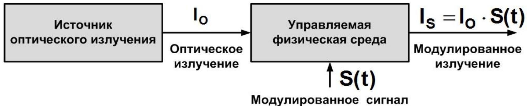
Принцип внешней модуляции
