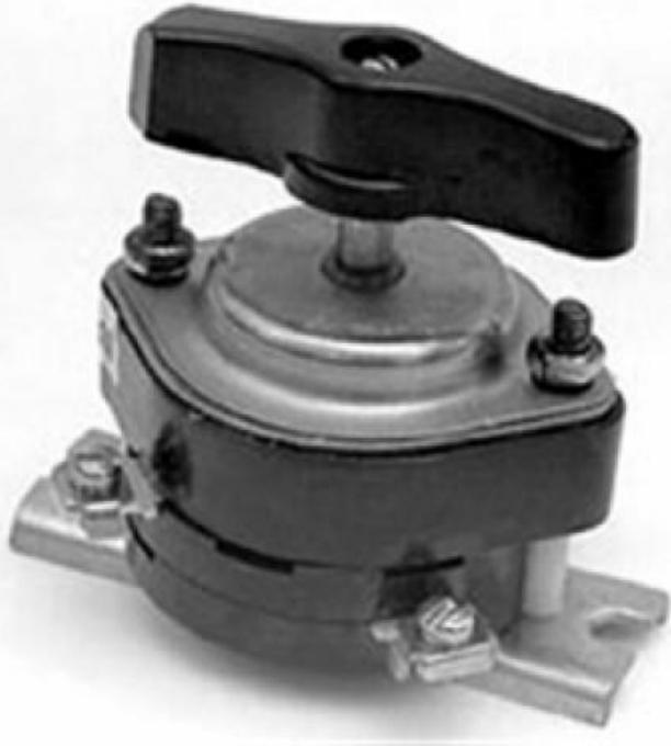
Пакетные выключатели и переключатели типа состоят из отдельных колец-пакетов, выполненных из изолирующего материала. Внутри пакета помещается контактная система, состоящая из неподвижного и подвижного контактов.
