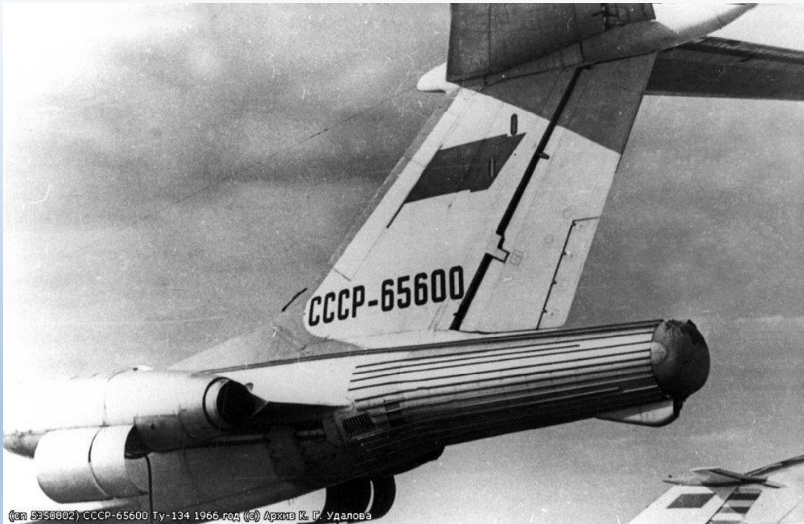
Опытный ТУ-134 с противостопорным парашютом
