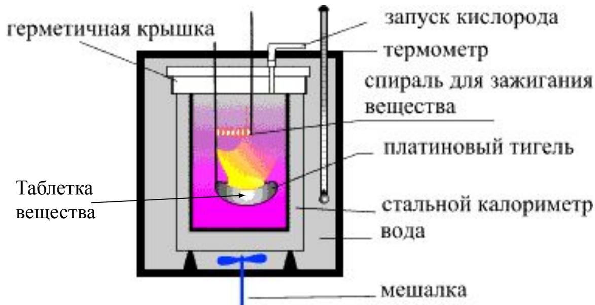
Калориметрическая бомба М1108. Объем 342 мл. Давление кислорода до 40 атм. Изготовлена из стабилизированной ниобием нержавеющей стали, устойчивой к действию азотной и серной кислот.
