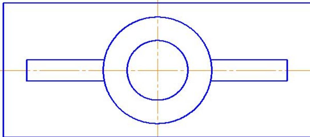
**Тонкие стенки (ребра жесткости)** разрезанные плоскостью вдоль, в ортогональных проекциях показываются разрезанными, но **не заштриховываются**. В аксонометрии они штрихуются. Не заштриховывают также спицы колес, если секущая плоскость проходит не поперёк, а вдоль них.
