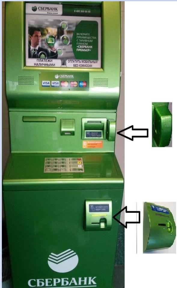
Видеокамера для записи ПИН-кода вмонтирована в накладку на штатный выступ, в котором расположена камера купюроприемника. Наличие камеры можно определить по небольшому отверстию с внутренней стороны выступа.
