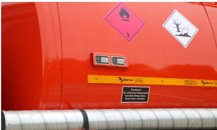
Водитель многосекционной автоцистерны, с помощью коррозионной таблички может узнать максимальную **вместимость** отдельных секций цистерны и когда прошло **испытание**.
