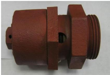
**Предохранительный клапан**- установленный на цистерне и обозначенный в четвертой части кода цистерны, служит для **предотвращения разрушения** цистерны вследствие чрезмерного повышения или понижения давления в ней.
