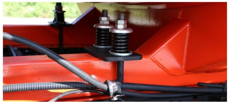
Кабели должны быть надежно закреплены, защищены от механических и термических повреждений и так, чтобы вероятность их воспламенения или короткого замыкания в случае аварии была минимальной.
