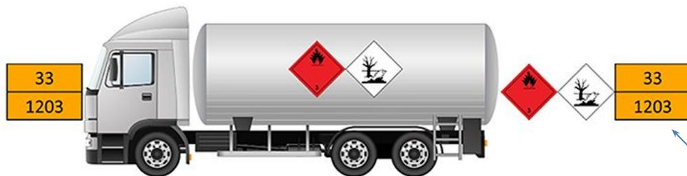
В верхней части- идентификационный номер опасности, удвоение цифры- усиление опасности. **Если впереди X- опасно реагирует с водой**
