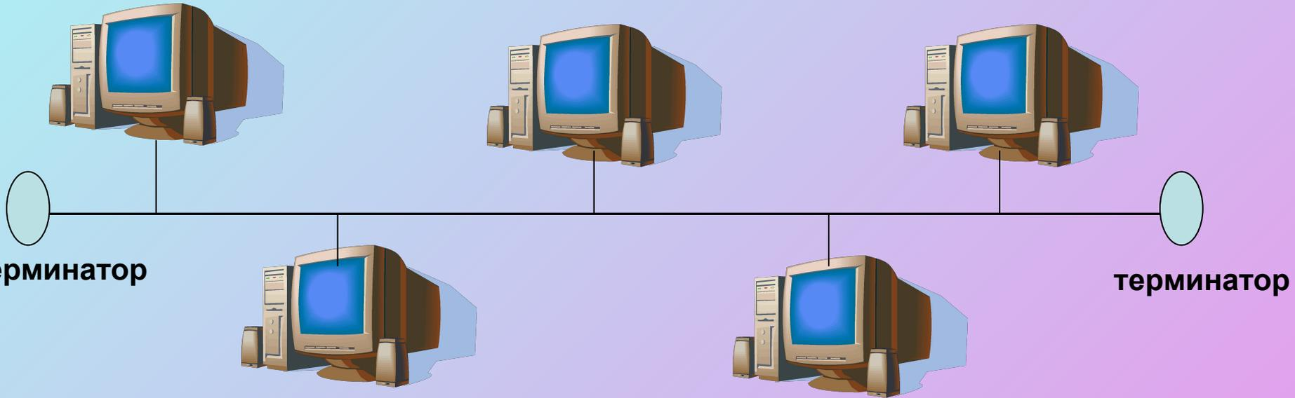
Используется один кабель вдоль которого подключены все компьютеры сети. Терминатор необходим для поглощения передаваемого сигнала на концах.
