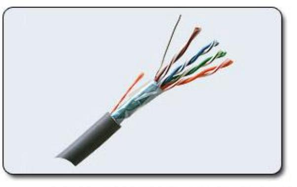
Кабель содержит две или более пары скрученных проводников, скрутка проводников скрученных одним с другим по всей длине кабеля. Наличие проводников скрученных уменьшает влияние внешних электромагнитных полей на передаваемые сигналы; самый дешёвый тип кабеля, скорость передачи информации 10-100 Мбит/с;
