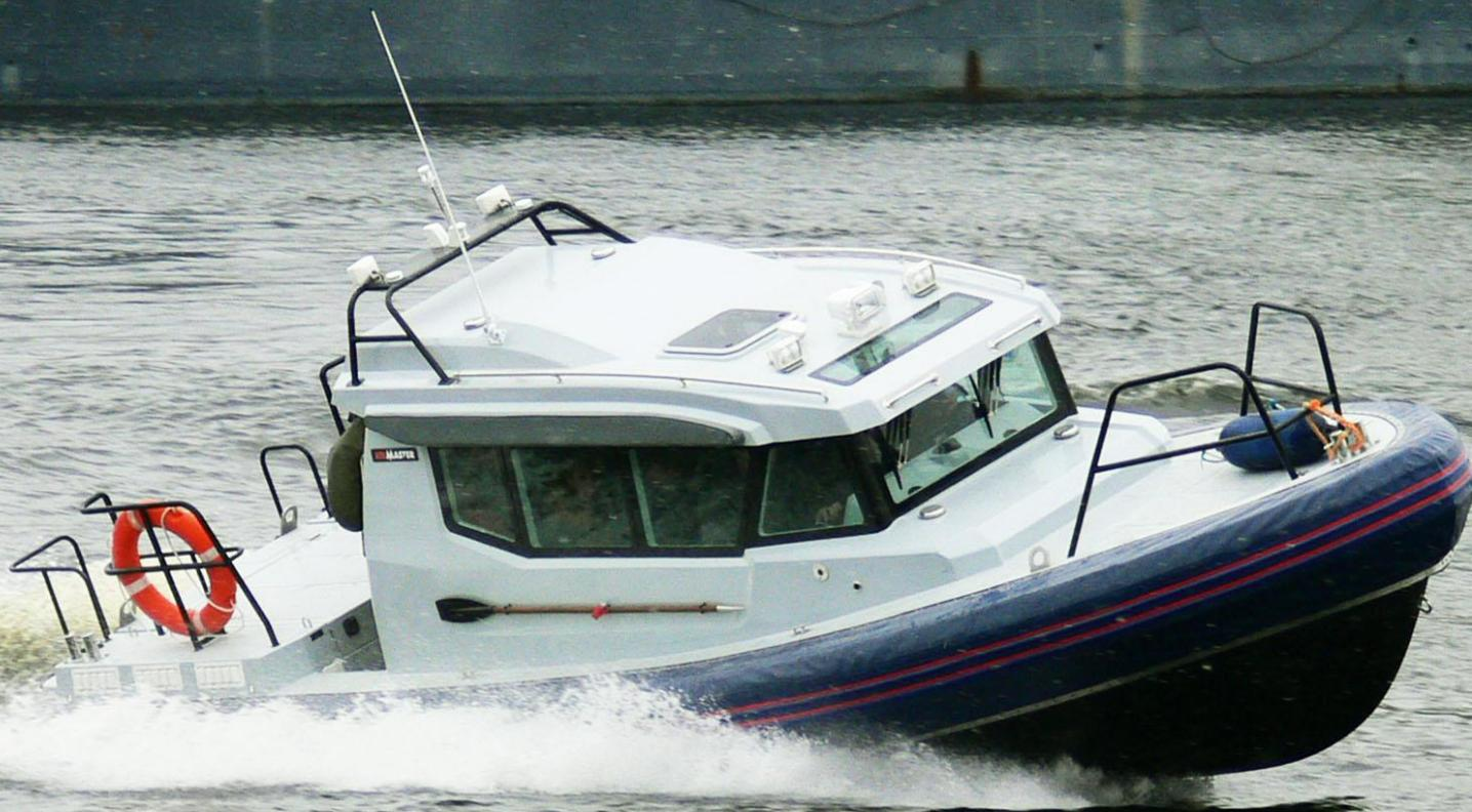
Катер предназначен для эксплуатации в пресной или морской воде в диапазоне температур воды от  $-2^{\circ}\text{C}$  до  $+32^{\circ}\text{C}$  и окружающего воздуха от  $-40^{\circ}\text{C}$  до  $+45^{\circ}\text{C}$ , при обязательном условии заправки двигателя соответствующим дизельным топливом.
